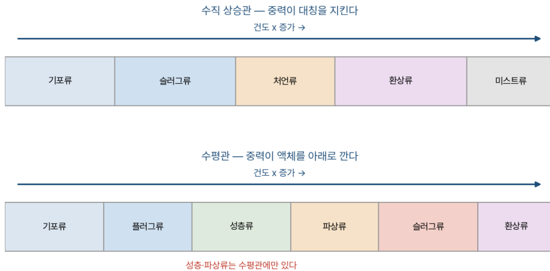
그림 11.1 — 수직관과 수평관의 유동 양식. 수평관에서는 중력이 액체를 아래로 깔아 성층·파상류가 추가된다. 31
